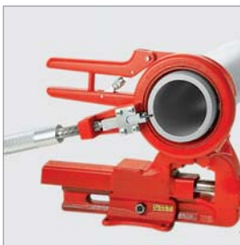
Зажим в параллельных тисках
